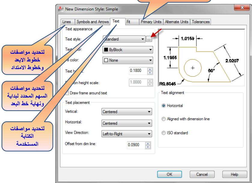
لانتهاء من تحديد مواصفات ال dimension style نضغط على set current لتفعيله أنواع الأبعاد التي يمكن وضعها على اللوحة **Horizontal dimension** Vertical dimension **Aligned dimension Radial dimension**
