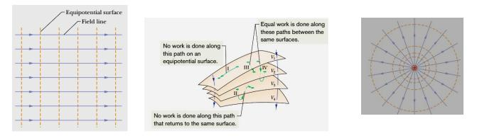
Figure 4.3: Equipotential Surfaces.
